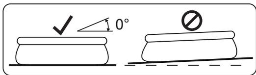
**IMPORTANT:** Si la piscine n'est pas nivelée, enlevez l'eau et nivelez de nouveau le sol en le creusant. N'essayez jamais de déplacer la piscine avec de l'eau à l'intérieur, cela pourrait provoquer de graves blessures ou endommager la piscine.
